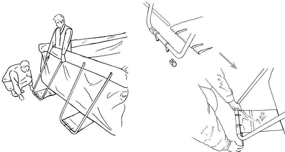
7. Nachdem sie alle V2A-Stäbe und V-Stützen montiert haben, montieren Sie den Skimmer (*siehe Bedienungsanleitung Filteranlagen*).
