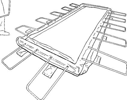
6. Beginnend an einer der 4 Schwimmbecken-Ecken fädeln Sie V2A-Stäbe (**F**) in die Boden-Laschen und die V2A-Ringe (**G**) der V-Stützen (**D**) ein. Wir empfehlen diesen Montageschritt zusammen mit einer Hilfsperson durchzuführen. Der Eine steht im Schwimmbecken und hält die V-Stütze hoch, während der Andere die V2A-Stäbe richtig einfädelt.
