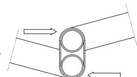
**9.** Achten Sie darauf, dass die Folie am obere Ende der ovalen Stangen überlappt. Nachdem Sie alle Stangen zusammengesteckt haben, drehen Sie alle ovalen Stangen um 90 Grad, sodaß die obere Beckenkante gespannt ist.
