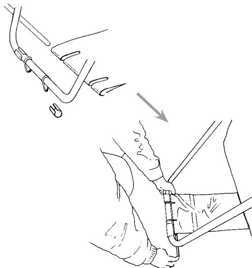
7. Une fois tous les petits tubes de fixation des sangles F installés, fixer le skimmer et sortir du bassin (cf: instructions de montage du système de filtration).
