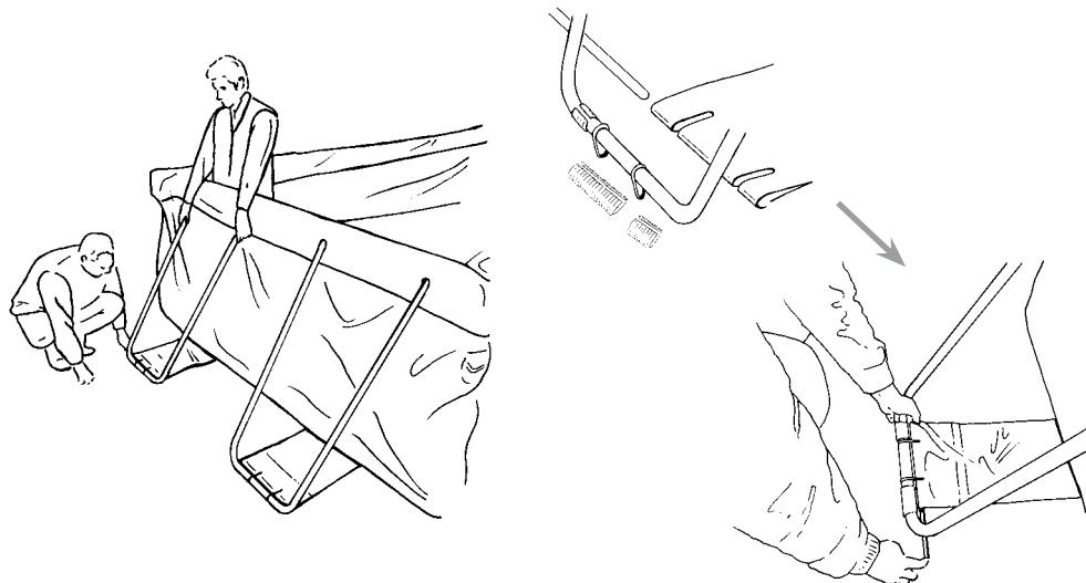
7. Nachdem sie alle V2A-Stäbe und V-Stützen montiert haben, montieren Sie den Skimmer (siehe Bedienungsanleitung Filteranlagen).
