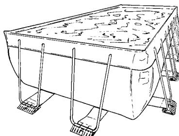
**ACHTUNG:** Beim gefüllten Schwimmbecken ist es nicht möglich irgendwelche Korrekturen durchzuführen. Die dafür nötige Kraft wäre so groß, dass Sie das Schwimmbecken mit Sicherheit beschädigen würden. (Denken Sie immer daran, welches enormes Gewicht Wasser hat). Falls Sie Änderungen durchführen wollen müssen Sie das Schwimmbecken vorher immer entleeren.
