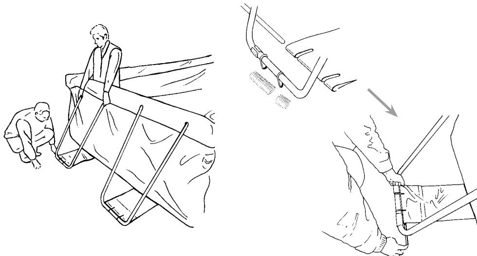
7. Una volta infilati tutti gli spinotti **F**, prima di uscire dalla vasca applicare lo Skimmer dell'impianto di depurazione (*vedi istruzioni Impianti di Depurazione*)).
