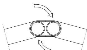
5. Completare l'assemblaggio della struttura inferiore collegando tutti i pezzi fino ad ottenere un cerchio chiuso con al centro il telo della vasca imbattuto.
