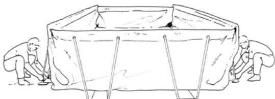
10. Brancher les tuyaux qui raccordent la piscine à la filtration (*cf. notice d'installation du système de filtration*)
