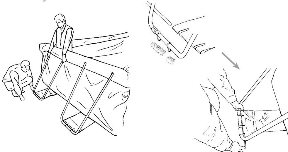
7. Une fois tous les petits tubes de fixation des sangles **F** installés, fixer le skimmer et sortir du bassin (*cf: instructions de montage du système de filtration*).
