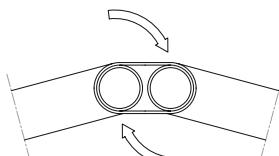
5. Continuer le montage de la partie basse de la structure en assemblant tous les morceaux de façon à former un cercle fermé avec au centre la toile encore emballée.
